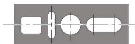
Отверстия с горизонтальными и вертикальными продолговатыми отверстиями
