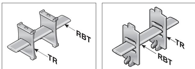
Полка в комбинации, по меньшей мере, с двумя разделительными перемишками составляет полочную систему. Дополнительные ярусы предотвращают перекручивание и минимизируют трение проводов между собой. Полки согласованы с величинами ширины цепи.
