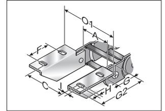
Цепное соединение поставляется по выбору из оцинкованной или высококачественной стали. Для крепления энергоцепи требуются два уголка (справа и слева) с отверстием и два
