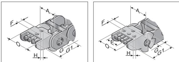
Цепное подсоединение представляет собой полностью пластмассовую деталь. Подсоединение точно согласовано с соответствующей шириной цепи и должно лишь защелкиваться на цепном звене. Просьба заказывать на цепь 1 штуку с отверстием и 1 штуку с пальцем. Подсоединения должны крепиться винтами размером М3. Проводные линии или, соответственно, шланги могут закрепляться на интегрированной разгрузке от натяжения цепного подсоединения с помощью кабельных стяжек.
