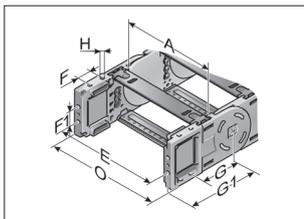
Это цепное подключение предоставляет универсальные возможности подключения (вверху, внизу, с торцевой стороны) и крепится как боковое звено на конце цепи. За счет этого последнее звено до самого подключения является подвижным. Каждой цепи необходимо одно подключение с пальцем и одно подключение с отверстием. Крепление производится с помощью листовых вставок и винтов размером M5.
