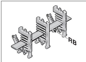
Полки RBD служат для горизонтального разделения по всей внутренней ширине цепного звена. В комбинации с разделительной перемычкой TRT может реализовываться дополнительное вертикальное разделение.
