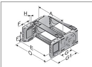
Это цепное подключение предоставляет универсальные возможности подключения (вверху, внизу, с торцевой стороны) и крепится как боковое звено на конце цепи. За счет этого последнее звено до самого подключения является подвижным. Каждой цепи необходимо одно подключение с пальцем и одно подключение с отверстием. Крепление производится с помощью листовых вставок и винтов размером M5.
