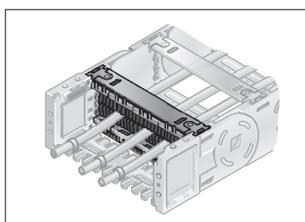
Посредством щеточных держателей проводные линии проводятся по нейтральной оси. Это инновационное решение специально разрабатывалось для случаев применения, когда из-за большого числа циклов движения усиливается истирание проводных линий.
