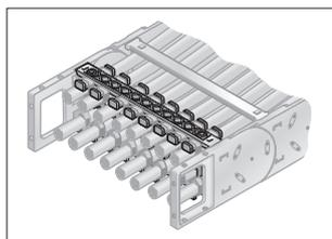
Жестко интегрированные разгрузки от натяжения на рамочных переключках цепных подсоединений. Адаптированы ко всем величинам ширины рамочных переключек до 200 мм. Можно монтировать во внутренней и наружной дугах на обоих концах цепи.
