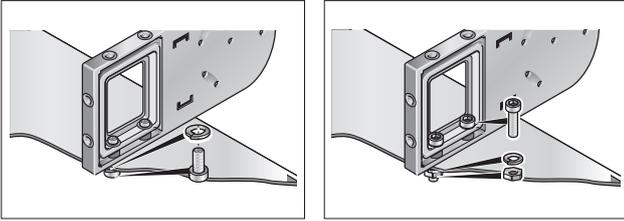
Латунные втулки гарантируют продолжительное закрепление без пластической деформации пластмассы в холодном состоянии
