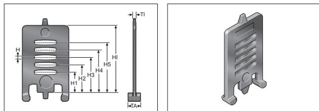
Прокладка нескольких круглых проводных линий или шлангов с различными диаметрами можно рекомендовать только при использовании разделительных перемычек. Закрытая перемычка используется в случаях, когда не используются полки. Это рекомендуется для путей перемещения длиной от 30 м.
