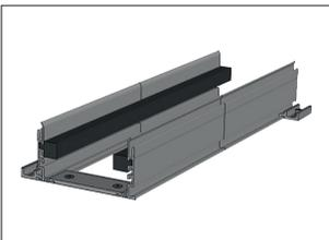
Для этой энергоцепи в распоряжении имеется вариативная система направляющего канала из алюминиевых профилей. За счет вариативного направляющего канала энергоцепь надежно поддерживается и направляется. Ассистент по выбору ищите в главе „Вариативная система направляющих каналов“.
