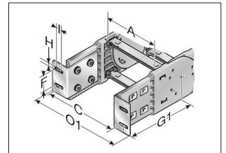
Для цепного подключения имеется несколько возможностей. В качестве стандарта поставляется подключение в стационарной точке внутри/внизу, захватное подключение внутри/вверху. Однако по желанию может поставляться любая другая комбинация.
