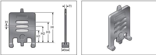
Прокладка нескольких круглых проводных линий или шлангов с различными диаметрами можно рекомендовать только при использовании разделительных перемычек.
