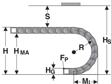
Захватное подсоединение должно быть прикручено на высоте H<sub>MA</sub> для соответствующего радиуса. Установочные размеры должны учитывать значение «Монтажная высота H<sub>s</sub>».
