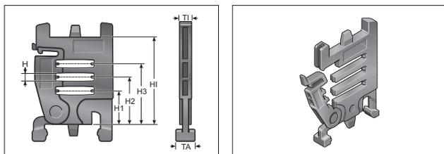
Две разъемных вертикальных перегородки (RTT) в комбинации минимум с одной полкой (RB) составляют простую в использовании полочную систему. Дополнительные ярусы предотвращают перекручивание проводов и минимизируют их трение друг о друга.
