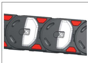
Чтобы свести к минимуму боковое истирание, скользящие пластины помещаются в боковую опору. Скользящие пластины используются вместо фиксации боковых элементов на боковых стыках (без инструментов). Предел износа составляет 2,5 мм. Когда этот предел достигнут, мы рекомендуем заменить кабельную тесьму. В зависимости от применения срок службы кабельной тесьмы в два раза выше при использовании пластин. Кабельная тесьма также может быть открыта в боковом положении.
