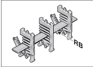
Полки RBD служат для горизонтального разделения по всей внутренней ширине цепного звена. В комбинации с разделительной перемычкой TRT может реализовываться дополнительное вертикальное разделение.
